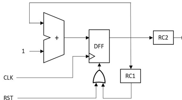
Per ridurre il modulo da 8 a 7 è necessaria una rete di reset che generi il reset – sincrono – quando il contatore raggiunge il valore 6, ovvero  $f_{RC1}(q_2, q_1, q_0) = q_2q_1\bar{q}_0$
